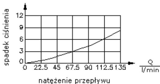
\frac{\Delta p}{\text{bar}} \Delta charakterystyka p-Q przy 28 cSt (50°C)
